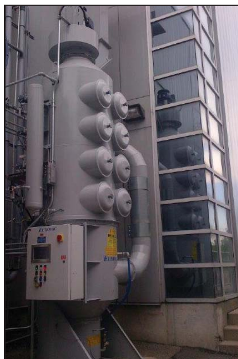
Les dépoussiéreurs CFS (Cyclonic Filter Separators) de Eurovac sont utilisés dans une grande variété d'applications et offre l'avantage de séparation cyclonique qui permet une durée de vie accrue des filtres ou cartouches.
