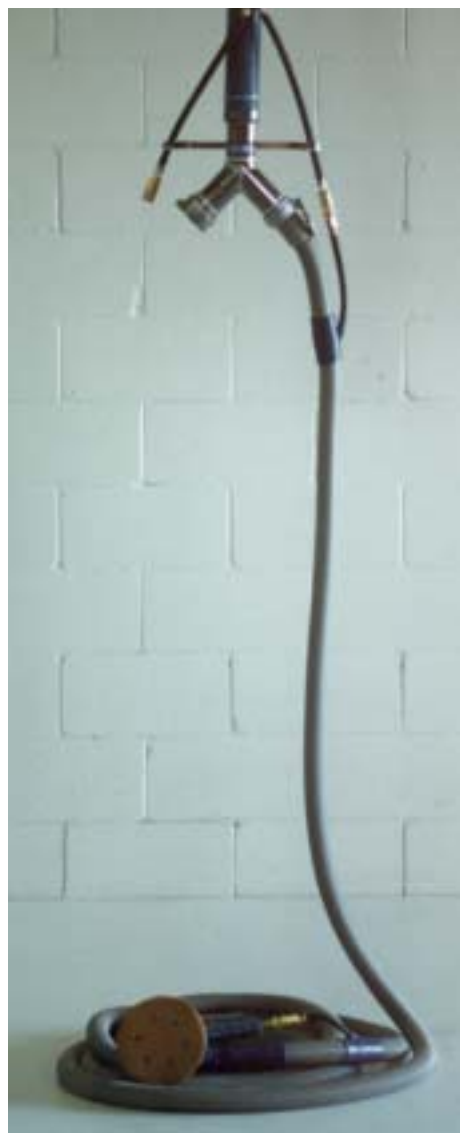
Module de travail double équipé d'un tuyau coaxial et d'une ponceuse orbitale.
